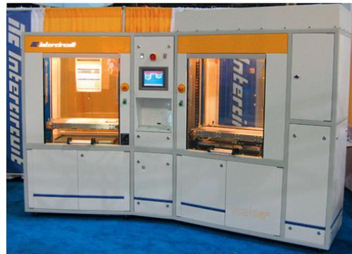
In der Hochvakuum-Füllanlage von Intercircuit wird die Plugging-Paste zuverlässig in Durchgangsbohrungen und Sacklöcher eingebracht
